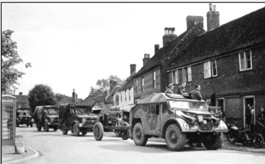
Een Canadese artillerie antitank eenheid. Een Guy Quad Ant met een Frans 75 mm kanon, gevolgd door drie Bedford MWD 15 cwt 4x2 vrachtwagentjes. De foto is gemaakt omstreeks 1944 in een niet geïdentificeerd dorpje in Kent. The War & Peace Glass Negative Collection nr. WanPs.0231
