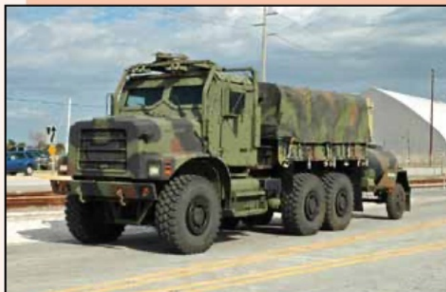
Truck, Algemeen, 6x6, wielbasis 4673 mm; Mk.23 Met gepantserde cabine (▲ en ▼).
